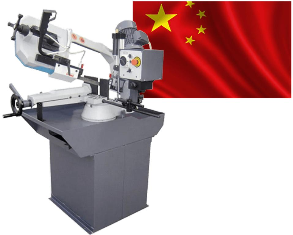
Консольный ленточнопильный станок FB280 с возможностью поворота пильной рамы в одну сторону.
